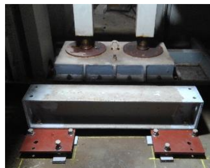
図 5 水平調節後の状況 (奥は既設ジャッキ)
