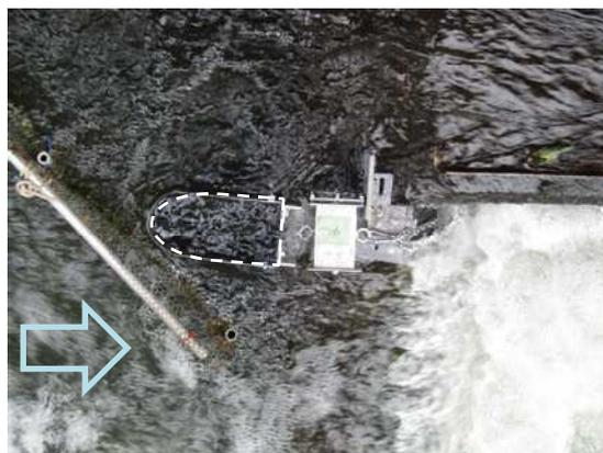
図 9 導流板設置後の流れ
