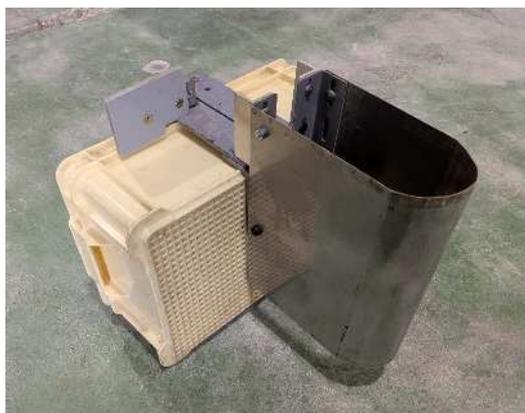
図 8 導流板及び止水板を取り付けた台
